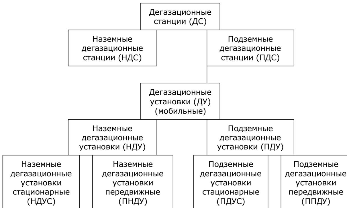
Рисунок 1. Схема ДС (ДУ)
